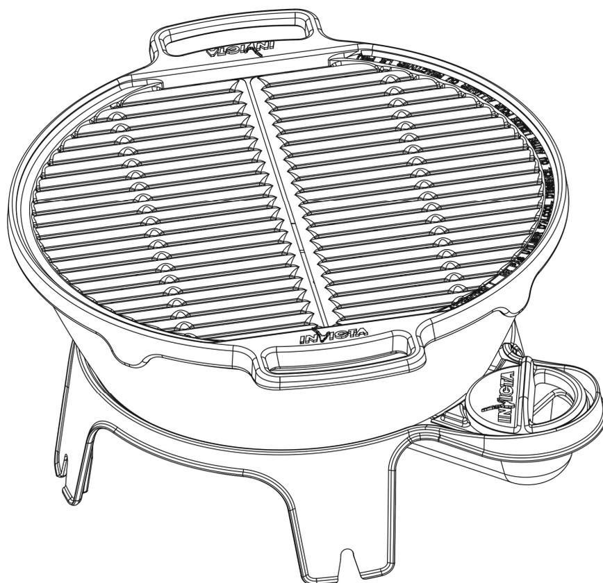
Tatoo Gril est un barbecue destiné à une utilisation en plein air, avec du petit bois ou du charbon de bois. Une commande de réglage de l'air primaire facilite l'allumage et permet d'ajuster l'allure du feu. L'allumage et le rechargement se font manuellement. Son fonctionnement ne nécessite aucune énergie auxiliaire.
