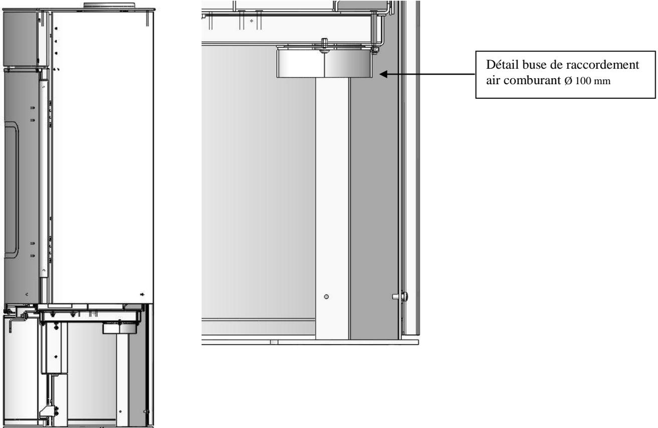
Ce poêle a été conçu pour être installé dans les maisons types BBC. Il est entièrement étanche et grâce à un raccordement (buse Ø 100), il permet de prendre l'air de combustion directement à l'extérieur sans le prélever dans la pièce. Il est compatible avec les solutions de ventilation de type VMC double flux et hygro-réglable.
