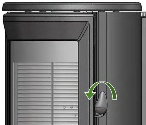
Figure n°14 - Fermeture de la porte
