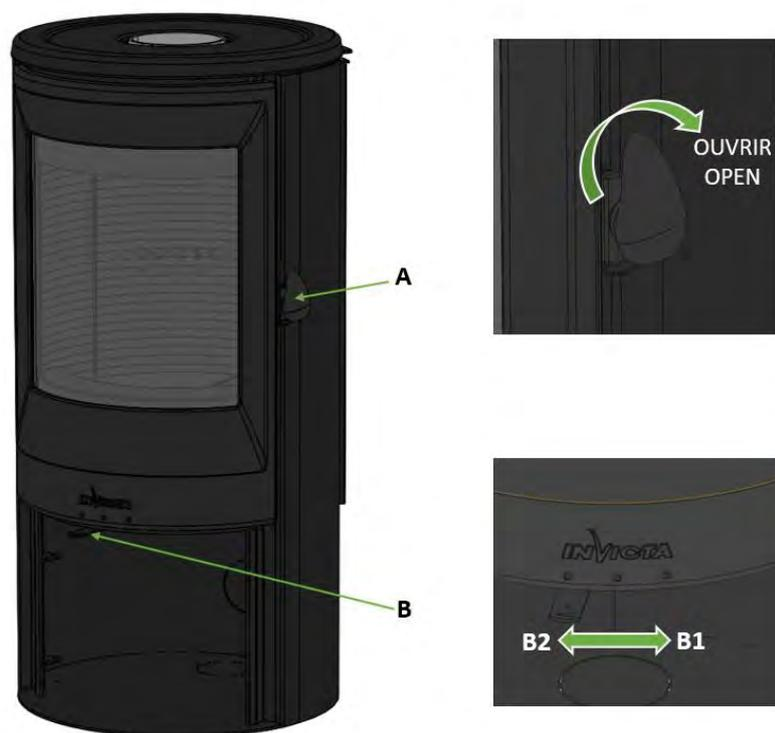
Figure n°10 - Éléments de fonctionnement de l'appareil
