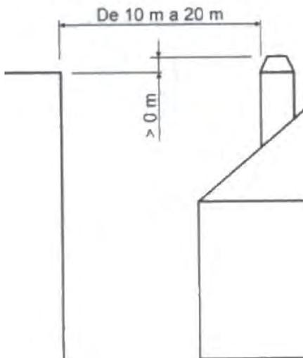
*Figure n°7 - Distances entre le sommet et les objets entre 10 et 20m*
