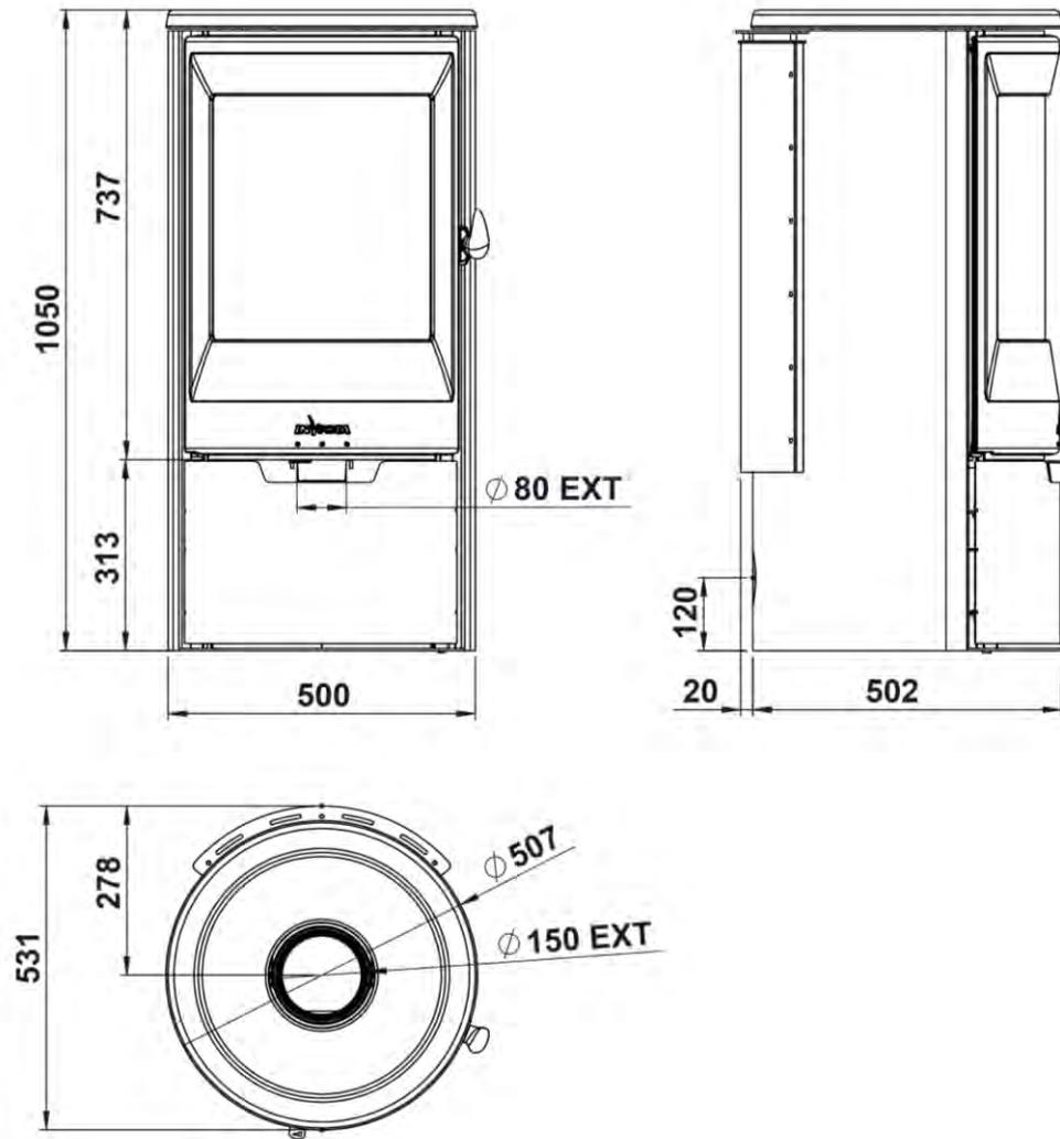
*Figure n°3 - Dimensions en mm de l'appareil NEOSEN ETANCHE*
