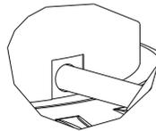
TO GUARANTEE THE CORRECT OPERATION OF THE FLUE KEY. PLEASE CUT THE FLUE ADAPTER AROUND THE FLAP SHAFT
