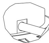
Pour garantir le bon fonctionnement de la clef de buse, merci de découper l'adaptateur fumisterie autour de l'axe du volet.
